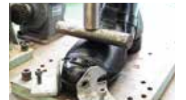
足甲プロテクタの耐衝撃性能試験
