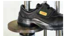
かかと部の衝撃エネルギー吸収性試験
