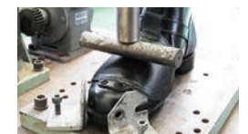
足甲プロテクタの耐衝撃性能試験
