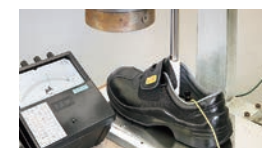
静電気帯電防止性能検査
